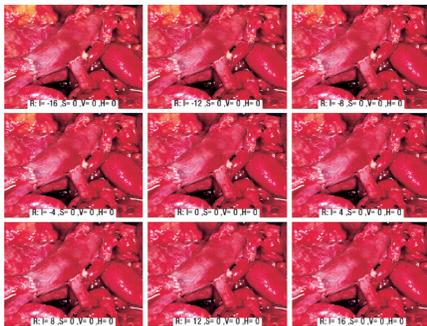
**Impresión de prueba de nueve divisiones para facilitar el ajuste del valor HSV (valor de saturación del tono)**
